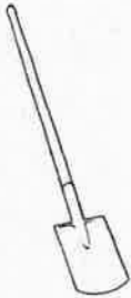
Bêche pour creuser et ameublir la terre ou pour la plantation en fente
